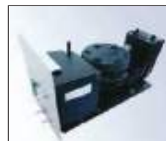
Portacubetas termostataado de 6 posiciones para cinéticas en cubetas de 10 mm de paso
