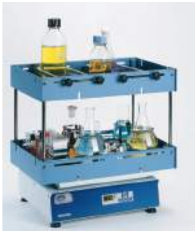
Plataforma doble código 3001011 adaptada al agitador código 3000974.
