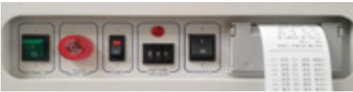
Panel de comando lateral con alarma visual y acústica. Incorpora impresora
