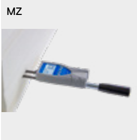
Medida de humedad en hojas de pulpa con densidad 450 a 900 kg/m³ directamente en la pila. Puede utilizarse para procesos de sulfato, sulfito y fibras de celulosa blanqueadas y sin blanquear.
