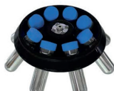
Cabezal angular | GNP034 50 mL×8 6000 rpm / 5150 ×g
