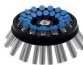
Cabezal angular | GLK008 15 mL×30 5000 rpm / 4100 ×g
